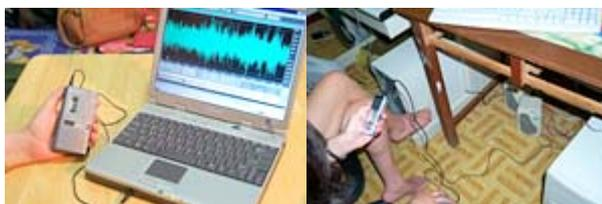
1. 需要一條聲音傳輸線將錄音機與電腦連接起來。這條錄音線的兩端有著跟一般隨身聽耳機或麥克風完全一樣的接頭。
